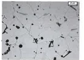
Sintrad mikrostruktur av 316L rostfritt stål.
