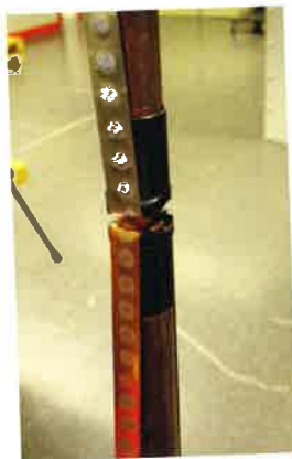
"Metalltejen" som täcker elektroden vid användandet av Fronius DeltaSpot.
